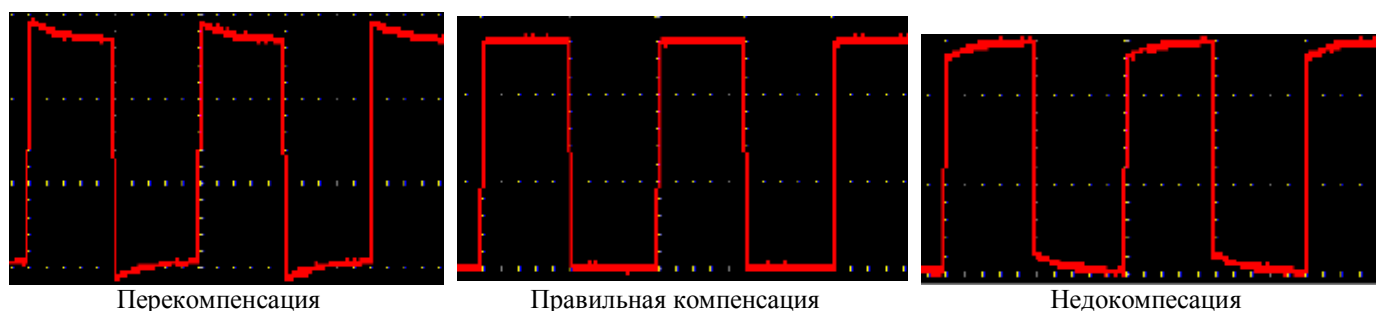
Рисунок 7. Форма сигнала при компенсации пробника
