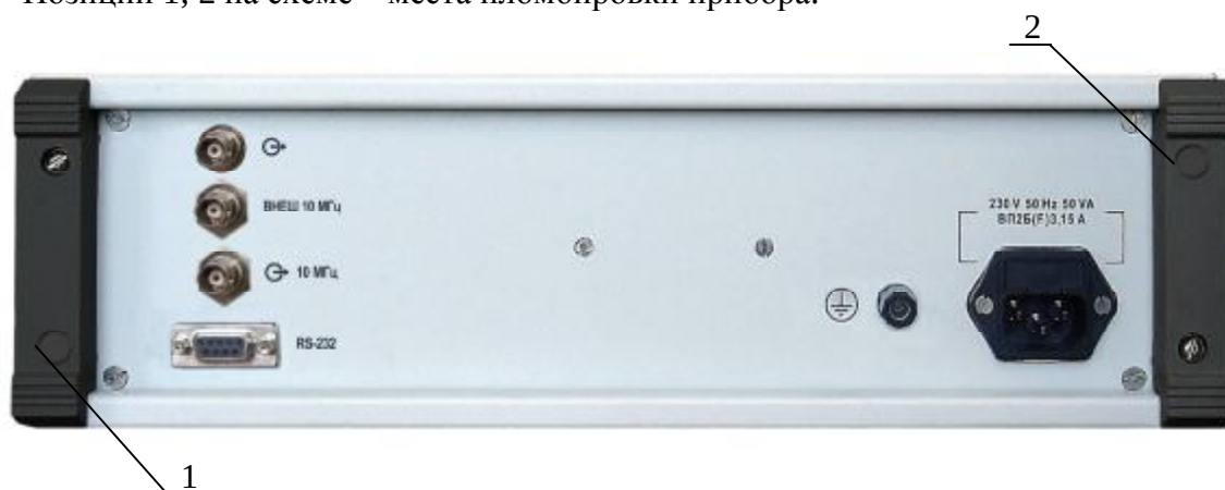
Рис. 2 Схема пломбировки прибора.
