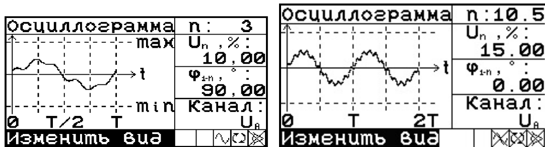
Рисунок 2.10 - Окно «Форма сигнала» в варианте представления «Осциллограмма» (слева — режим интергармоник выключен, справа — режим интергармоник включен)
