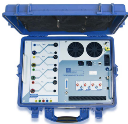
Эталонный электроэнергетический прибор сравнения (компаратор) «Энергомонитор 61850»
