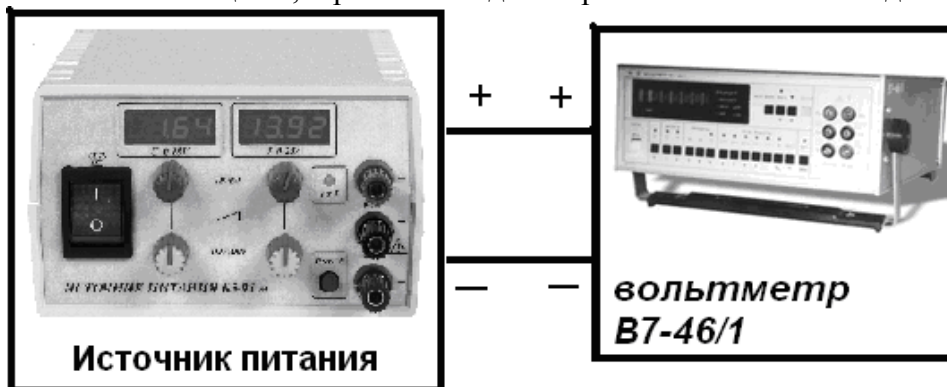
Рисунок 1 – Схема определения абсолютной погрешности измерения выходного напряжения ИП в режиме стабилизации напряжения
