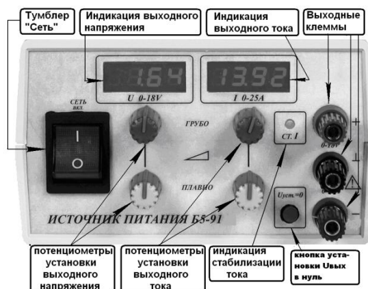
Рисунок 1.4 – Органы управления на передней панели источника питания.
