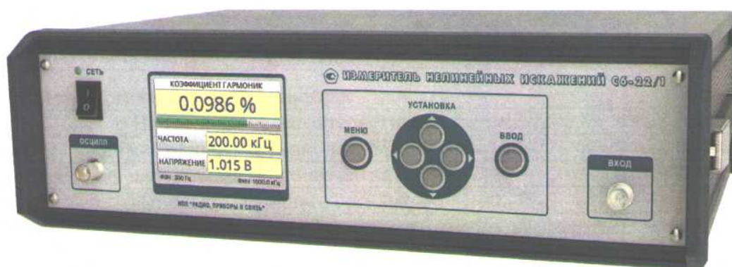
Рисунок 1 - Общий вид измерителя нелинейных искажений С6-22/1
