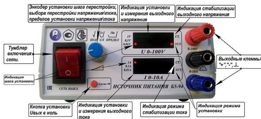
Рисунок 1.4 – Органы управления на передней панели источника питания.
