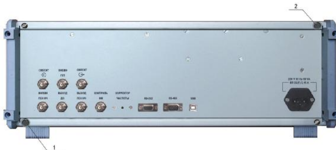
Рис. 2 Схема пломбировки установки.
