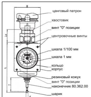
Рис. 1. Описание конструкции, габариты.
