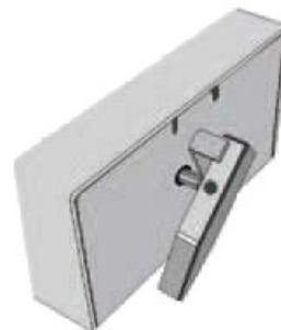
Шаг 4. Повернуть рычаг для установления контакта с чипом
