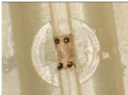
Ячейка с 4-я прижимными контактами
