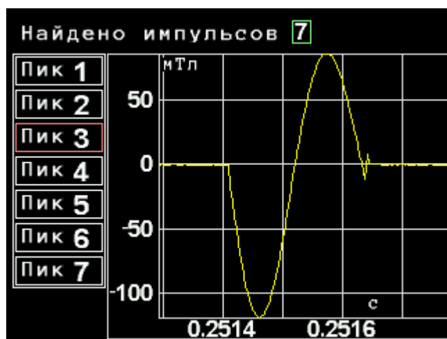
Рисунок 3.24. Графическое отображение вида выбранного импульса в режиме измерения параметров импульсного магнитного поля. Режим «Тесламетр»
