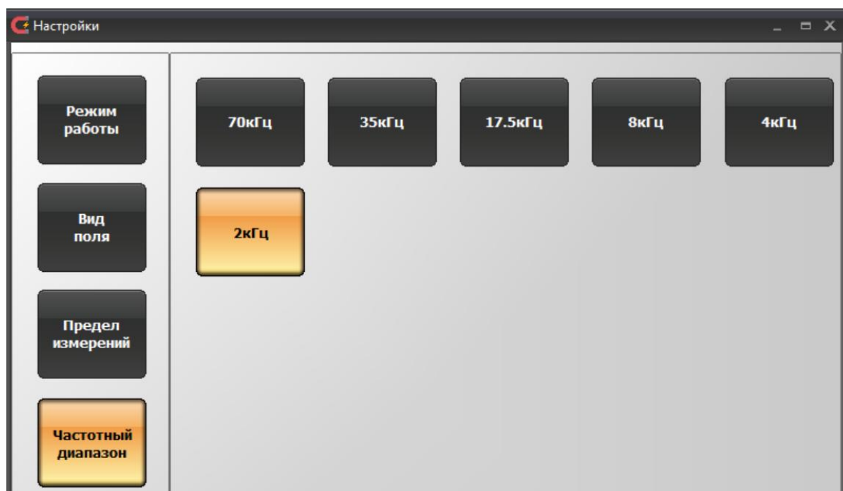
Рисунок 17. Окно настроек программы управления ТПУ-2В в режиме «Тесламетр». Группа параметров «Частотный диапазон», измерение переменного магнитного поля
