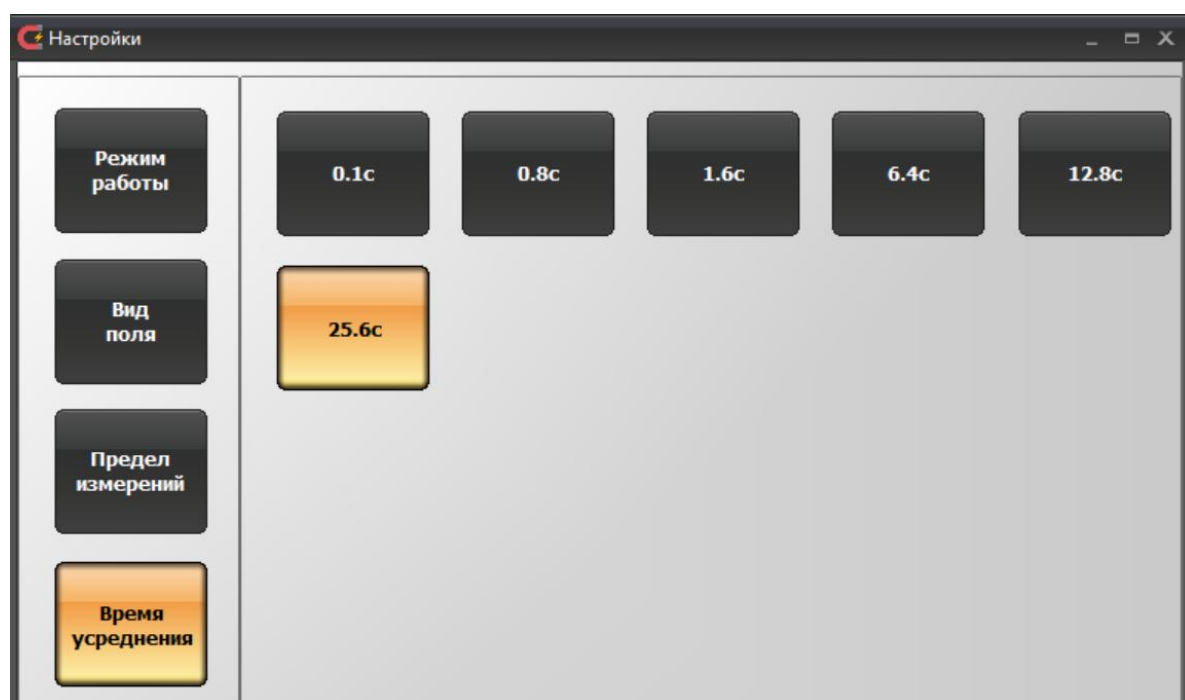
Рисунок 16. Окно настроек программы управления ТПУ-2В в режиме «Тесламетр». Группа параметров «Время усреднения», измерение постоянного магнитного поля
