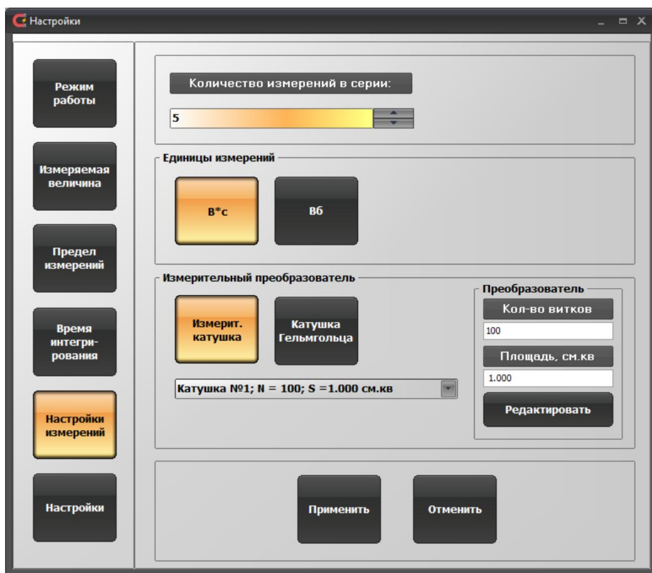
Рисунок 10. Окно настроек программы управления ТПУ-2В в режиме «Веберметр». Группа параметров «Настройки измерений»
