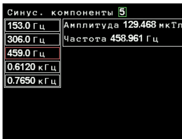
Рисунок 3.18. Результаты определения гармонических составляющих магнитной индукции в режиме отображения результатов «Гармоники» при измерении параметров переменного магнитного поля. Режим «Тесламетр»
