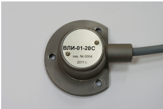
а) б) Рисунок 1- а) внешний вид виброметра ВЛИ б) внешний вид блока коммутации БК
